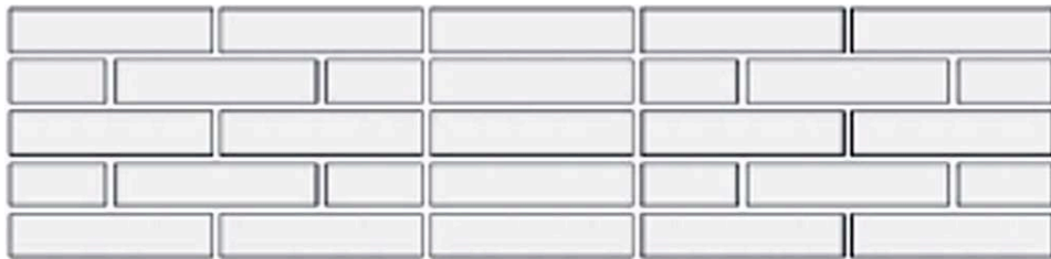
Lösung C: 45 Stück/m 2 rechteckiger Vetropieno 30 Stück/m 2 quadratischer Vetropieno
