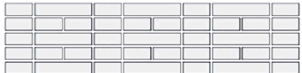
Lösung D: 45 Stück/m 2 rechteckiger Vetropieno 30 Stück/m 2 quadratischer Vetropieno
