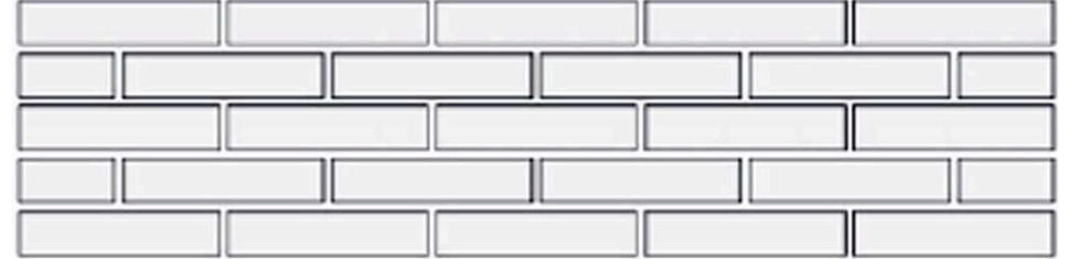
Lösung B: 53 Stück/m 2 rechteckiger Vetropieno 14 Stück/m 2 quadratischer Vetropieno
